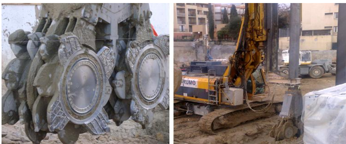
Figura 2 – Pormenor da ferramenta de corte (à esquerda) e aspeto geral do equipamento de execução dos painéis CSM (à direita)
