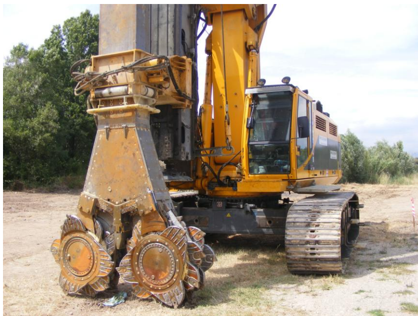
Figura 7 – Fotografia do equipamento utilizado na execução de painéis CSM (fotografia do autor)
