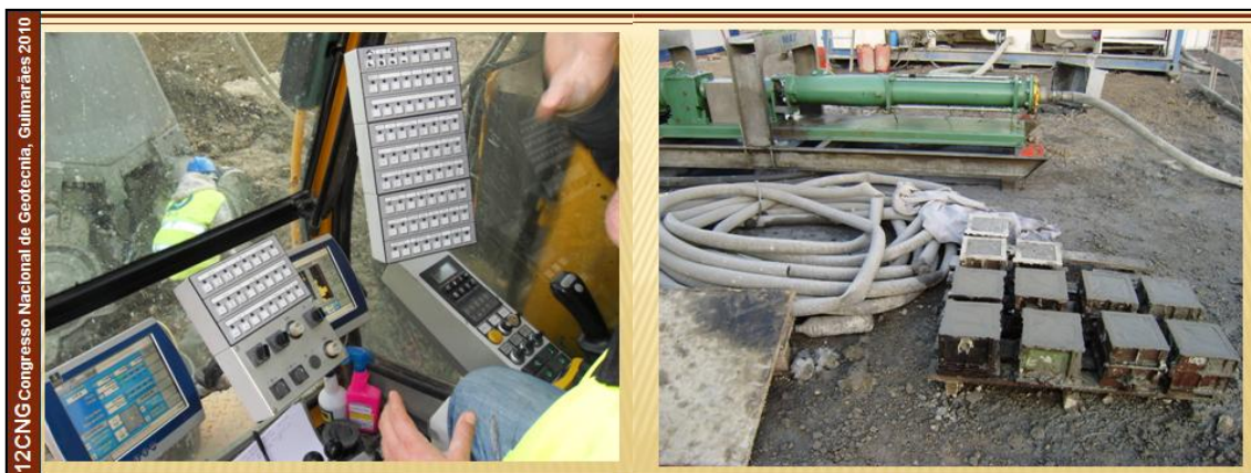
Figura 7 – Painel de aparelhos para Controlo de Execução e provetes para Ensaios de Compressão Uniaxial, não confinada, com medição de Módulo de Deformabilidade
