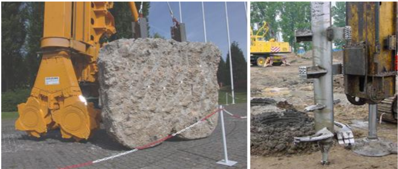
Figura 9 – Equipamento de CSM com rotação em torno de eixos horizontais e vista de um painel de CSM (à esquerda) e ferramenta de execução de DSM com rotação em torno de um eixo vertical (à direita)
