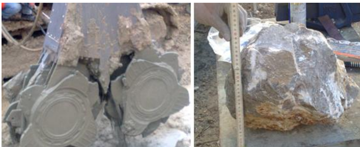
Figura 12 – Ferramenta de corte (à esquerda) e bloco rochoso recolhido durante a escavação (à direita)
