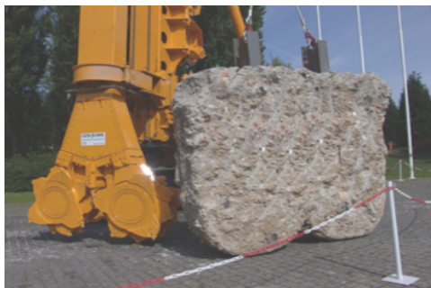
Figura 1. Equipamento de CSM com rotação em torno de eixos horizontais e vista de um painel de CSM
